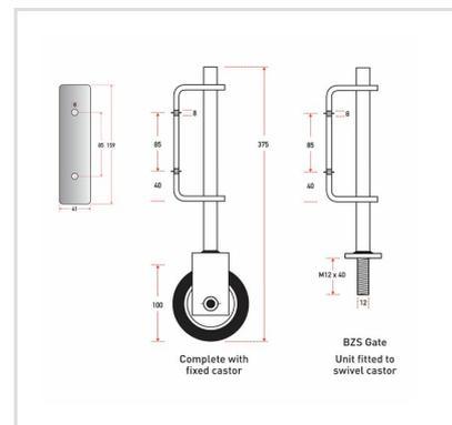
GEHÄUSE: STAHLBLECH SCHWARZ LACKIERT, FEDERWEG 75 MM RADKÖRPER AUS STAHL ELASTIK-VOLLGUMMIREIFEN 75 ± 7 SHORE A AUFVULKANISIERT, SCHWARZ ODER GRAU
